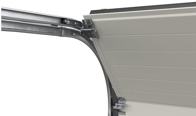
**Bild 2:** Die verbesserte Zargenkonstruktion der neuen Hörmann Industrie-Sektionaltor Generation ermöglicht durch optimierte Laufschiennenradien und vergrößerte Laufrollen einen leiseren und verschleißarmen Torlauf.
