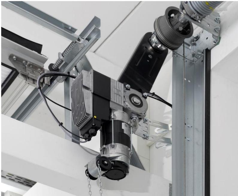
**Bild 4:** Der neue Hörmann Industrietor-Antrieb WA 500 FU ermöglicht in Kombination mit der Steuerung 560 eine maximale Öffnungsgeschwindigkeit von bis zu 1 m/s. Durch die hohe Torlaufgeschwindigkeit stehen die Tore deutlich kürzer offen, sodass Energieverluste reduziert werden.
