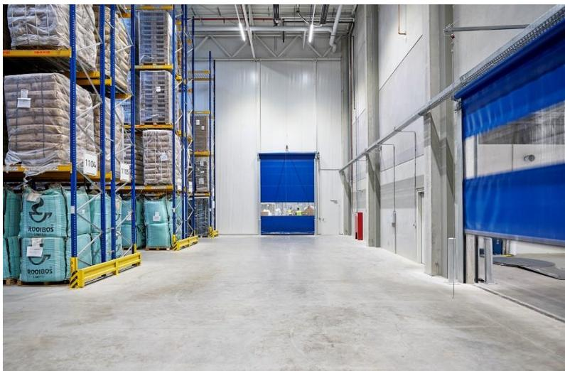
**Bild 4:** Die im In-Time Logistikgebäude eingesetzten Hörmann Schnellauftore dienen als Abschluss des Tee-Lagers. Durch ihre besonders schnellen Öffnungs- und Schließzeiten verhindern die Tore, dass sich das Aroma auf angrenzende Hallenbereiche ausbreitet. Außerdem sorgen sie durch ihre schnelle Öffnungsgeschwindigkeit für reibungslose Arbeitsabläufe.
